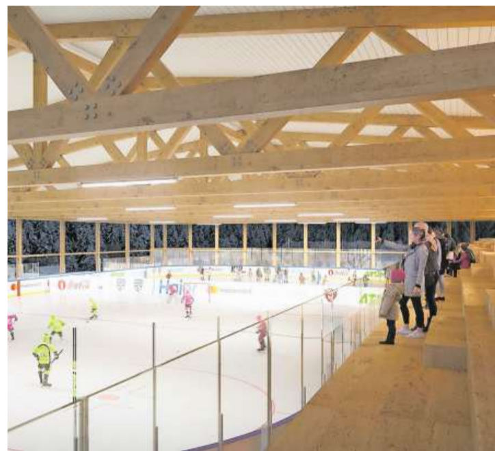
Die Kunsteisbahn im Holzboden in Spiringen ist gedeckt, hat aber keine geschlossene Gebäudehülle. Dadurch braucht es keine Belüftung.
