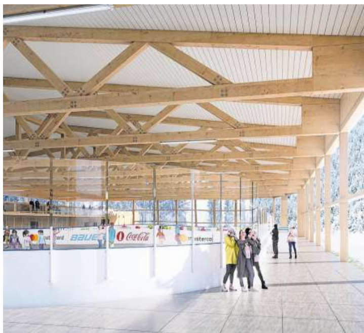
Die Kunsteisbahn im Holzboden in Spiringen ist gedeckt, hat aber keine geschlossene Gebäudehülle. Dadurch braucht es keine Belüftung.
